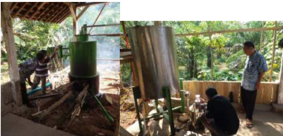
Gambar 29. Proses penyulingan minyak sereh wangi ( lemon grass oil )
